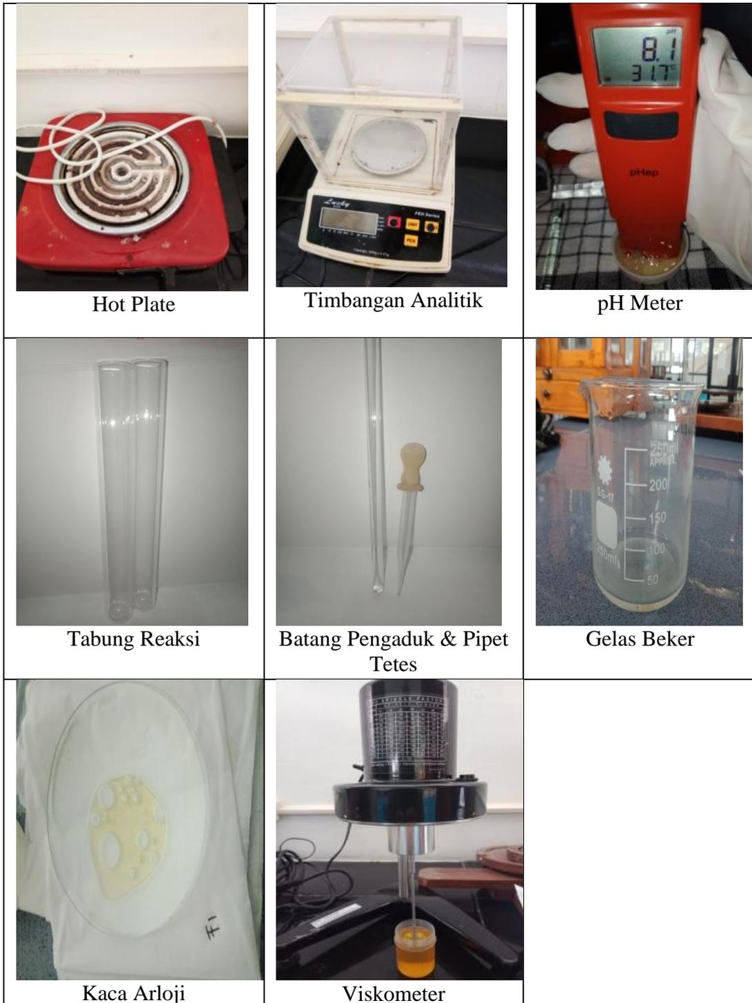
**Gambar 10. Alat yang digunakan pembuatan sabun cuci piring minyak atsri bunga kecombrang**
