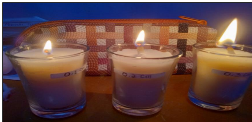
Gambar 10. Perbandingan Hasil Uji Nyala Biolilin Aromaterapi Minyak Atsiri Bunga Kecombrang Etlingera elatior (Jack) R.M. Smith sebagai repellent nyamuk.
